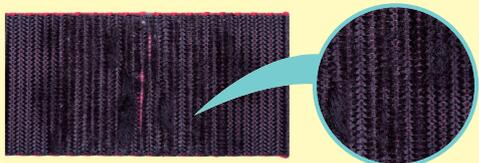
(6) D環取付部の耳に2mm以上の傷・擦り切れがあるもの
